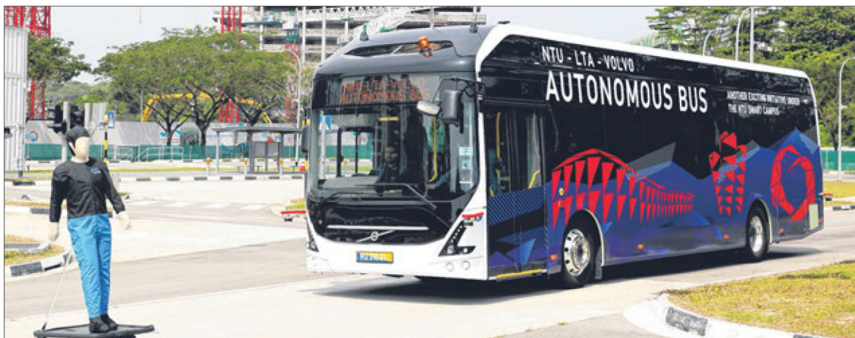
这辆12米长的无人驾驶电动巴士安装先进的探测系统，一旦探测到前方有障碍物，就会自动停下来。（邱启聪摄）
