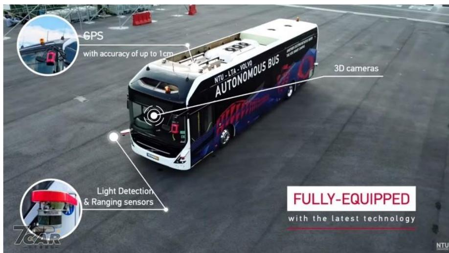
Volvo 7900 電動公車配備了眾多感知器與控制系統，包含光達、雷達、360 度鏡頭與即時衛星定位系統，並由 AI 系統統一管理，為了確保資訊安全，其系統還受到高規格的資安防護，以防止遭到惡意入侵。Volvo Buses 部門總裁 Hakan Aanevall 表示，Volvo 7900 是全球第一台全尺寸的自動駕駛電動公車，它可以改變公共交通的體系，並提升營運效率與安全性，對於環境也有幫助。目前電動車與自動駕駛技術是許多車廠和科技公司首要的發展目標，單從研發到測試都需經不少年時間，透過 Volvo 與南洋理工大學的校園測試，相信能促進業界技術層面快速發展。
