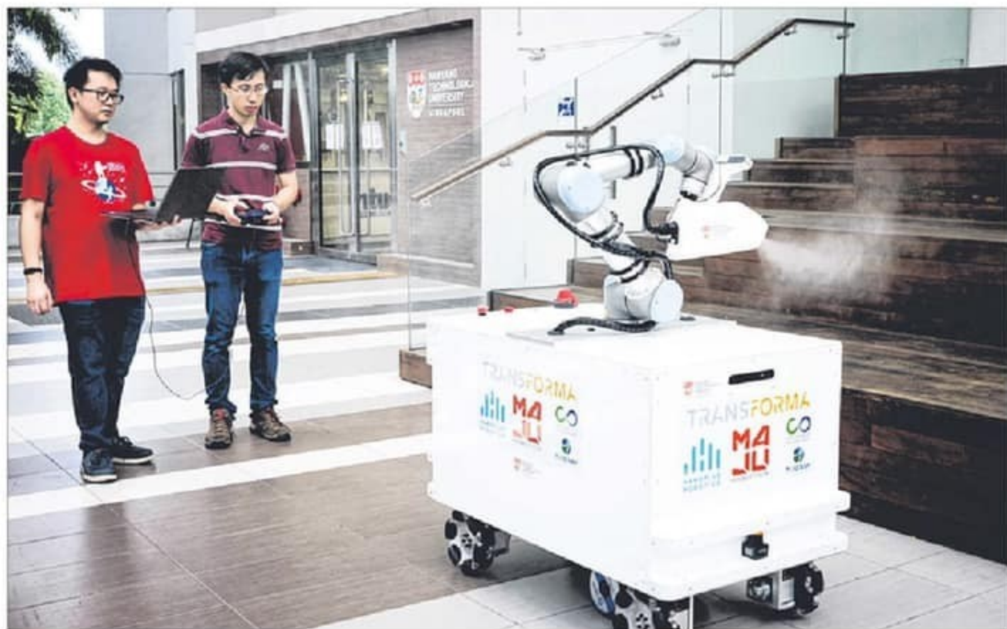
南大发明XDBOT消毒机器人，可在短时间内对大面积区域喷洒消毒液，覆盖面积可增加至传统消毒方式的四倍。（南洋理工大学提供）
