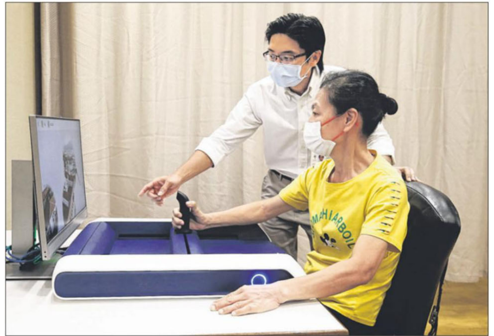
包括薛柔姿在内，中风病患未来料将有更多机会使用“H-Man”便携式手臂复健机器，在治疗师指导下，通过游戏完成机器发出的指示，用手控制操控杆，加强臂力，进行复健。（陈渊庄摄）
